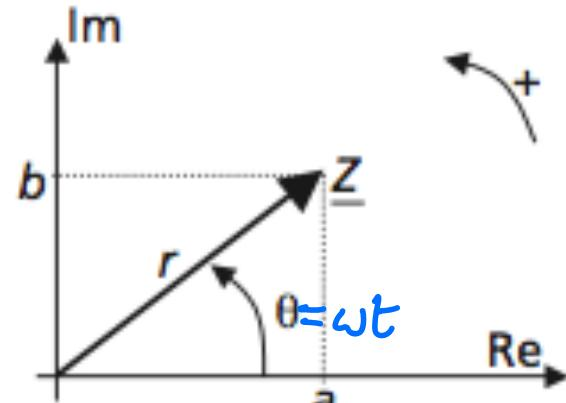
On voit qu'une tension pourra être représentée par un complexe et sa **partie réelle** est la projection sur l'axe horizontal.
